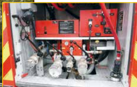
Système de pompe avec 3 possibilités : eau, mouillant, émulseur (mousse)
